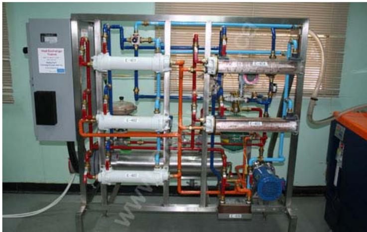
Unité de formation d'échangeur de chaleur avec contrôle en boucle PID
