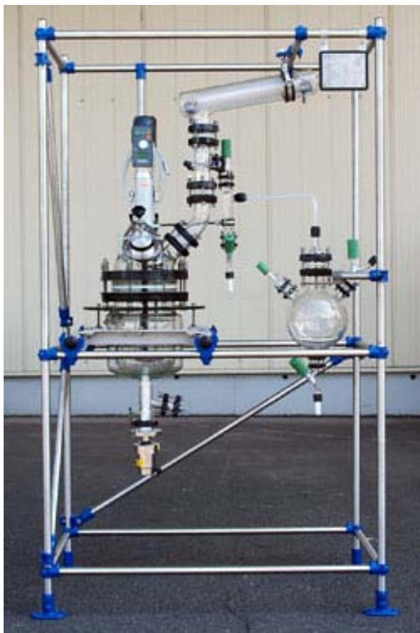
Réacteur standard avec colonne de distillation
