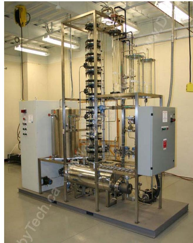
Unité de distillation binaire avec contrôle DCS
